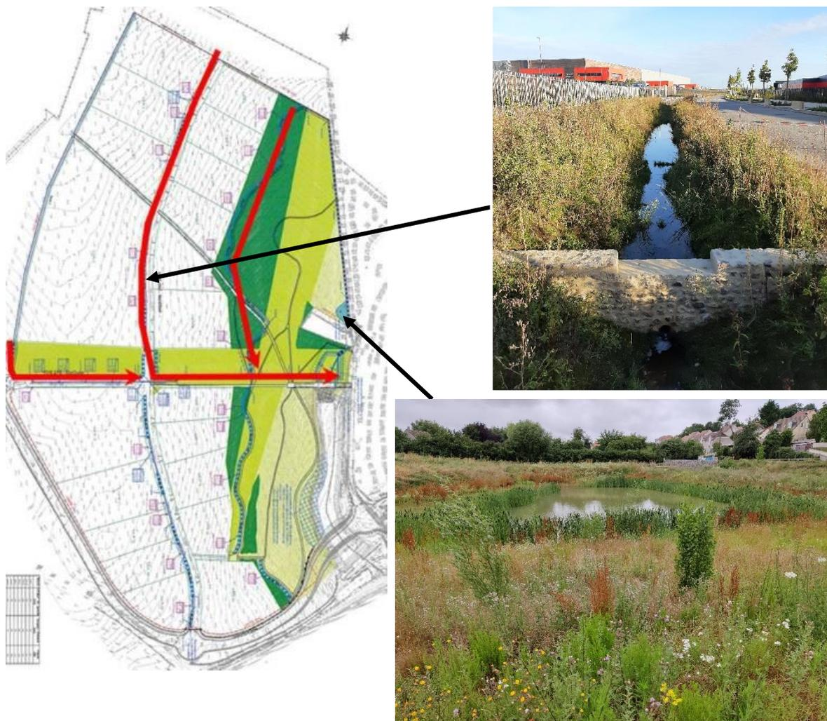
Figure 59 : axes d'écoulement des eaux pluviales (source Louvres, 2021), noue paysagère (source TRANS-FAIRE, 2021) et bassin de rétention des eaux pluviales de la ZAC de la Butte aux Bergers (source Grand Paris Aménagement, 2021)
